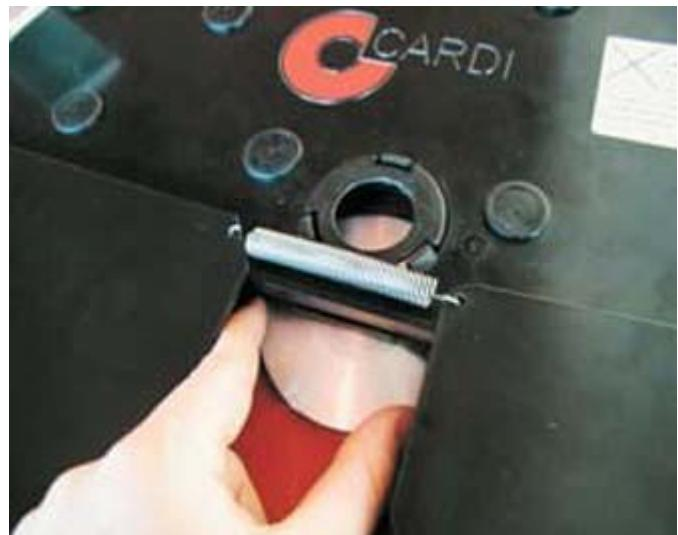
Вставьте болт крепления диска в отверстие в шпинделе и затяните его трубчатым ключом. Затем вставьте на место эластичную заглушку.
