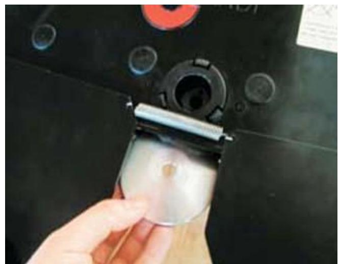
Установите алмазный диск на шпиндель. Для этого поднимите защитные экраны в крайнее верхнее положение. Затем установите на шпиндель передний фланец крепления диска.
