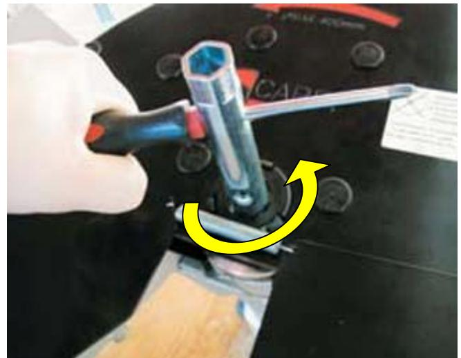
Выньте крепежный болт и снимите передний фланец крепления диска.
